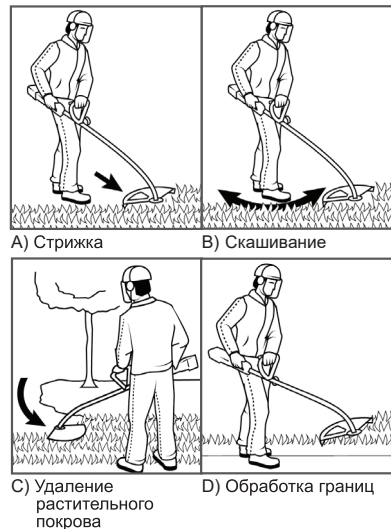
Рис. 9 Основные виды работ триммером
